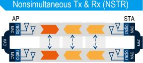
In-synch use of link pair Tx/Tx or Rx/Rx
